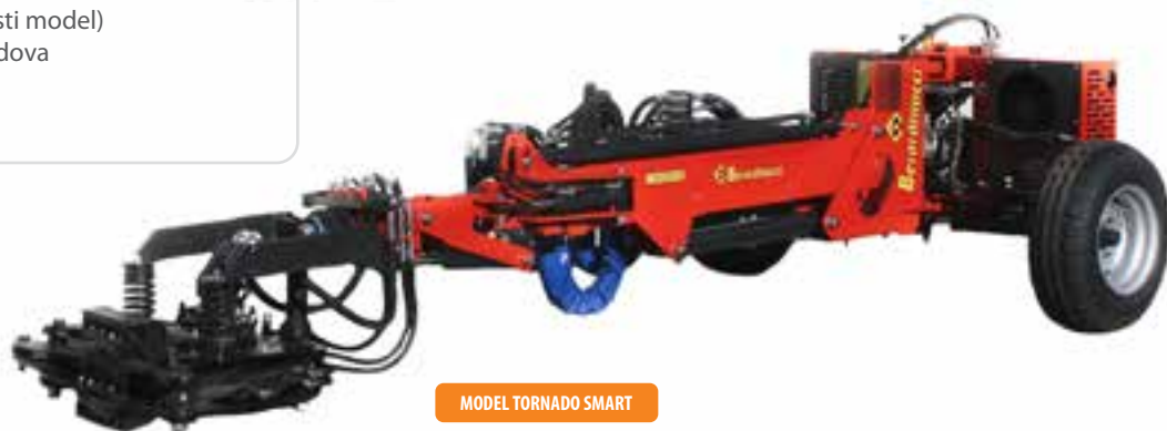
Vozno postolje, teleskopska ruka i vibrirajuća glava
