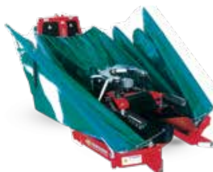
Prihvatni uređaj RMA 1 s vibrirajućom glavom
