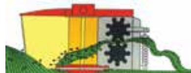
shematski prikaz rada gnječilice
